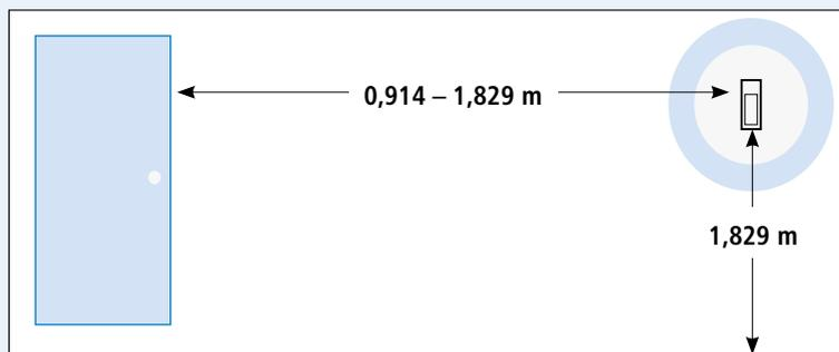
Coloque el dispensador en un punto donde el aire facilite la distribución de la fragancia y el neutralizador por todo el espacio, normalmente a entre 0,914 y 1,829 m de la entrada.
